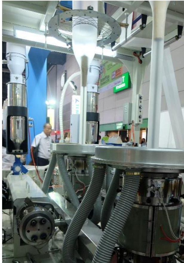
รูปที่ 2.22 เครื่องจักรเป่าถุงพลาสติกที่ใช้กระบวนการอัดรีดร่วมในการเป่าถุง 3 ชั้น
