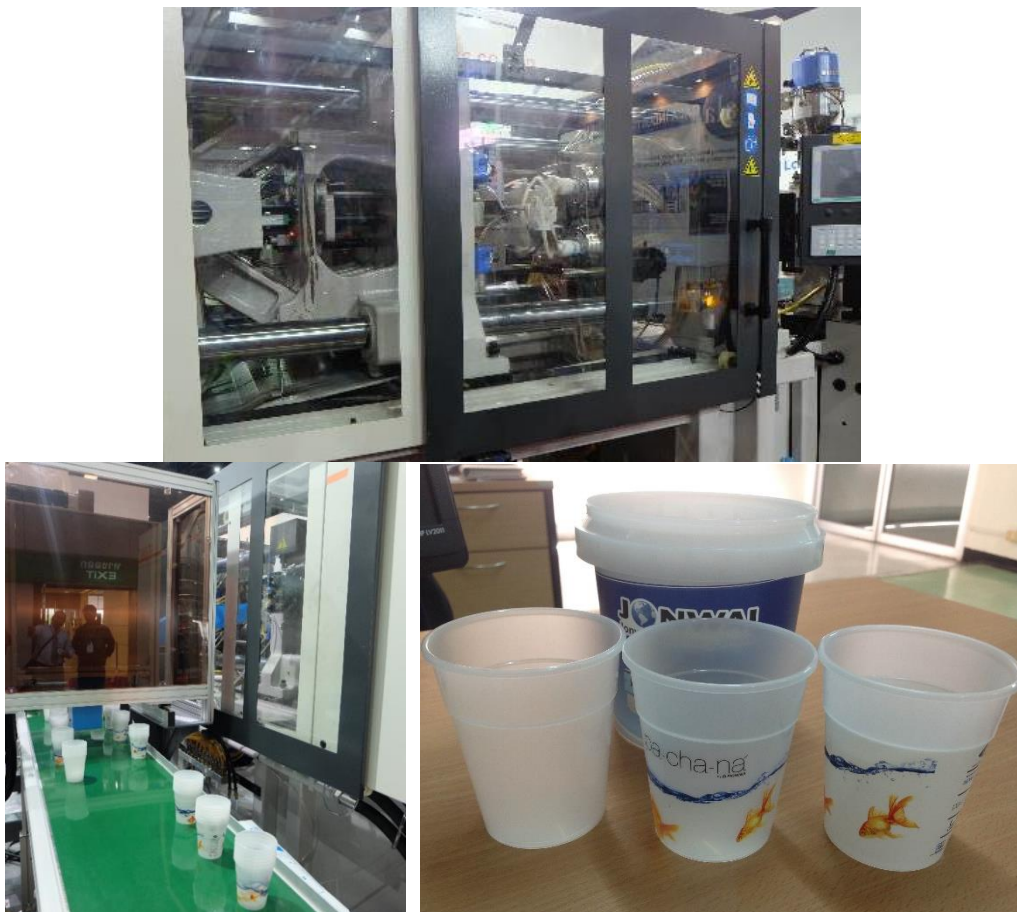
รูปที่ 2.25 เครื่องจักรฉีดพลาสติกและผลิตภัณฑ์ที่ได้จากกระบวนการฉีดแบบ In-mould Labeling
