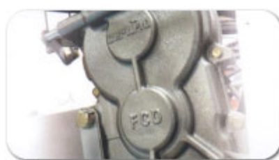
รูปที่ 3.7 ห้องเกียร์ที่ทำด้วยเหล็กหล่อเหนียว
